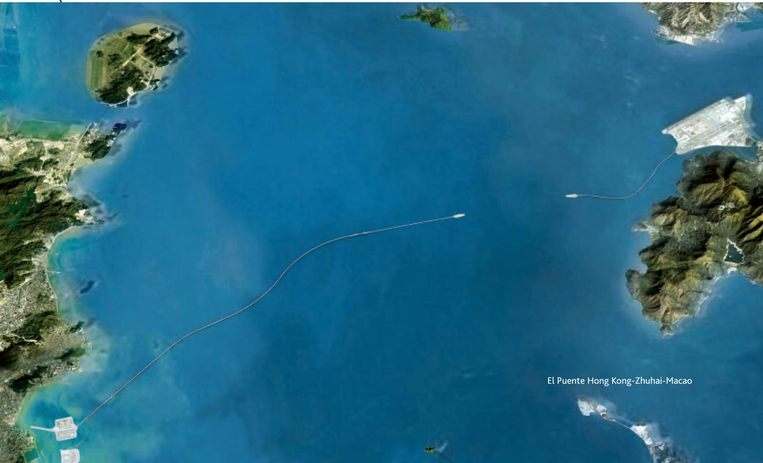
artificiales, lo que equivale aproximadamente a 22,5 kilómetros (14 millas) de viaductos y un túnel submarino de 6,8 kilómetros (4,2 millas).
