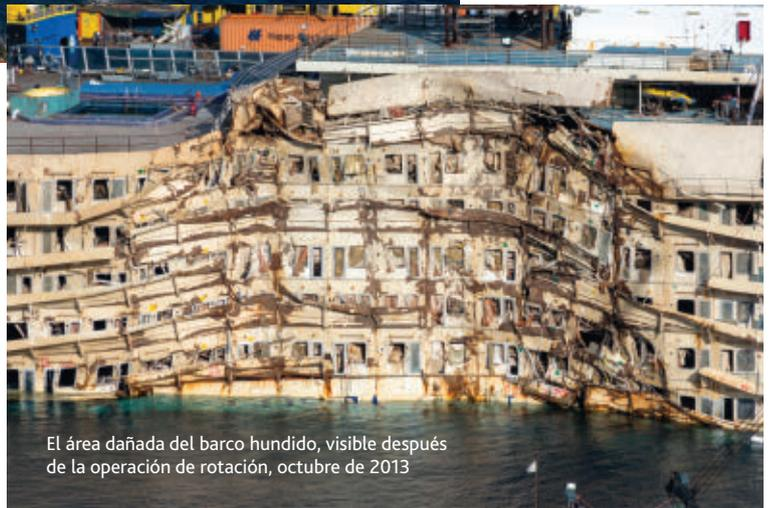
El área dañada del barco hundido, visible después de la operación de rotación, octubre de 2013
